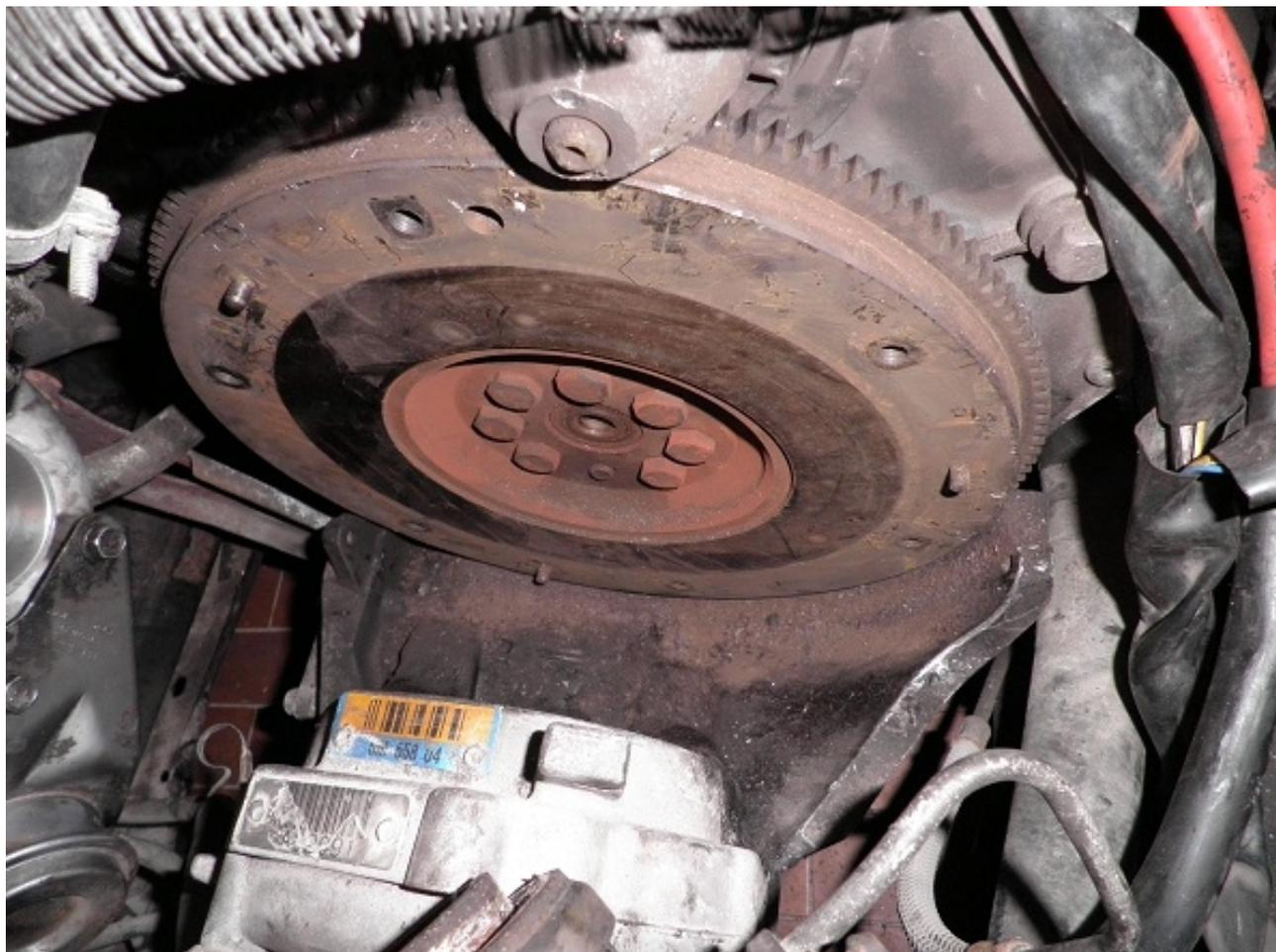
Per smontarlo portare il perno a ore 11, svitare alternatamente i bulloni (chiave da 17) e sfilarlo.
