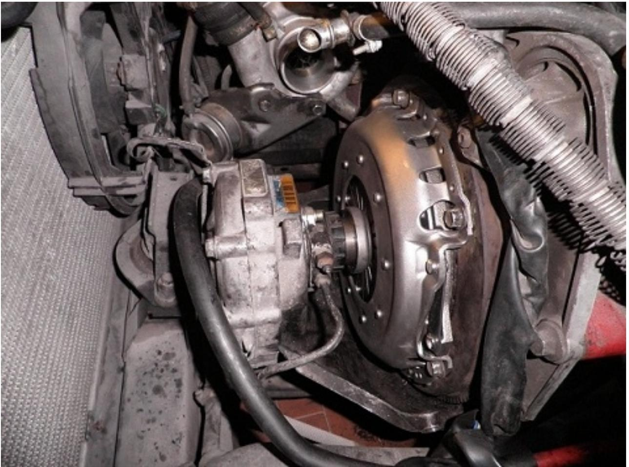
A questo punto, avvitare tutti i bulloni dello spingidisco e rimontare coperchio in plastica e i vari manicotti e intercooler smontati inizialmente.
