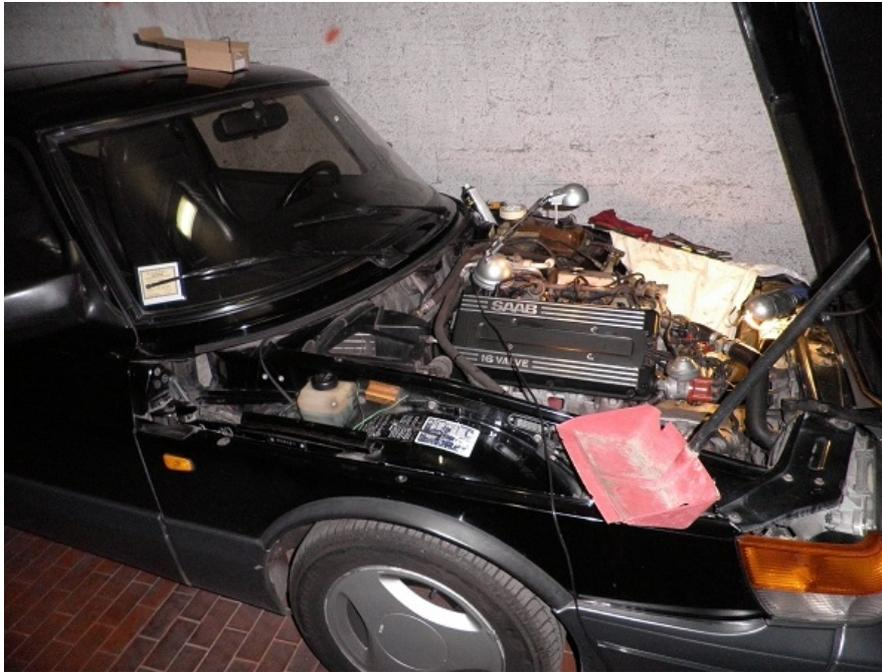
Nel sostituire la frizione alla mia saab ho scattato qualche foto ed ecco qua una breve guida per chi vuole cimentarsi nel lavoro che, data la disposizione del motore, non richiede ponte ma si lavora comodamente dall'alto.
